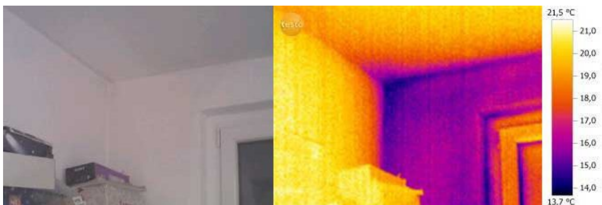
Obr. 4.1.3: Vnitřní pohled na tepelné ztráty [3]
