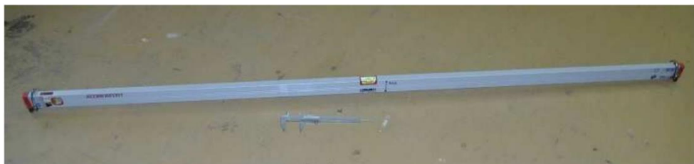
Obrázek č. 18: Vodováha na měření rovinnosti podkladu
