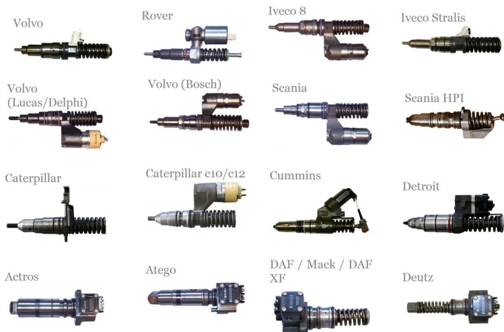
Obr. 2-14 Přehled vstříkovačů Čerpadlo – tryska, Čerpadlo – vedení – tryska [64]
