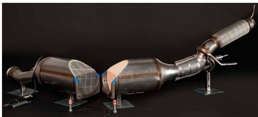
Obr. 4-15 Kombinace filtr pevných částic (vlevo) a SCR katalyzátor (vpravo) - motor blueHDI Euro 6 [53]
