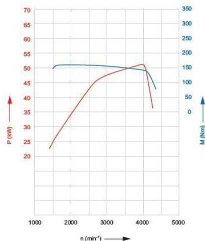
Obr. 5-13 Výkonová a momentová charakteristika motoru 1.4 TDI PD 51kW [32]
