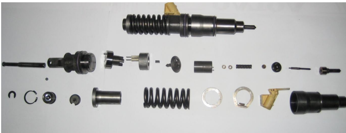
Obr. 3-2 Vstříkovač Delphi E1 rozložený na jednotlivé komponenty [80]
