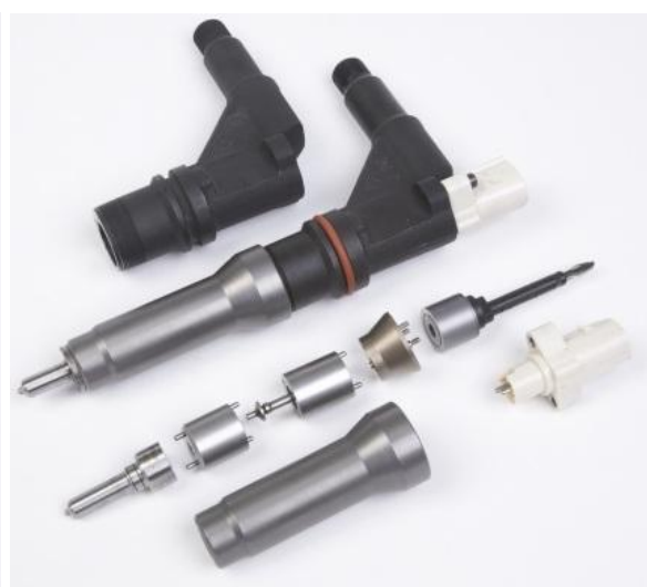
Obr. 3-5 Rozložený vstřikovač Delphi SMART [51]
