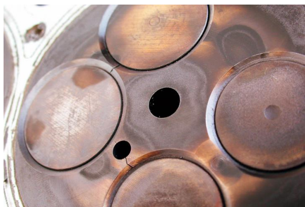
Obr. 5-34 Praskliny v hlavě válce (2.0 TDI 125kW) [72]
