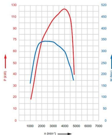
Obr. 5-27 Výkonová a momentová charakteristika motoru 2.0 TDI PD 8V 103kW [31]
