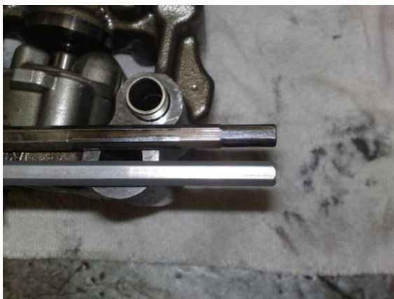
Obr. 5-36 Nový a opotřebený unášec pohonu olejového čerpadla [73]
