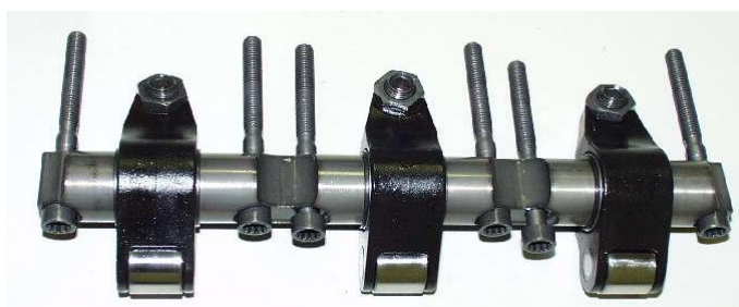
Obr. 1-8 Ovládání vstřikovacích jednotek vahadlem [24] Obr. 1-9 Vahadlo (zde tříválcový motor 1.4 TDI) [36]
