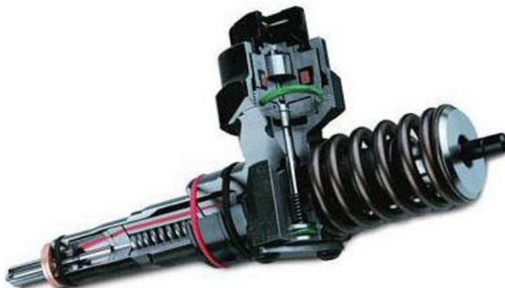
Obr. 1-2 Řez sdruženou vstříkovací jednotkou [78]
