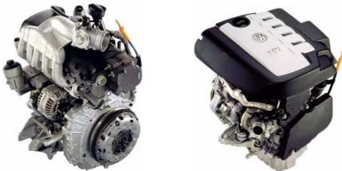
Obr. 5-40 Příčná zástavka motoru do VW Transporter (vlevo) a podélná zástavba motoru do VW Touareg (vpravo) [42]
