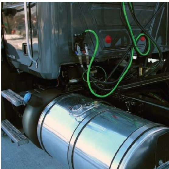
Obr. 4-18 Nádržka na AdBlue (s modrým uzávěrem) na vozidle MACK [54]
