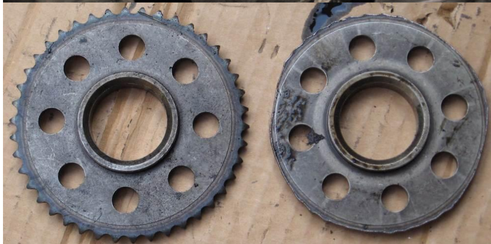
Obr. 5-35 Oholené zuby ozubeného kola pohonu (pomocí řetízku) olejového čerpadla [69]
