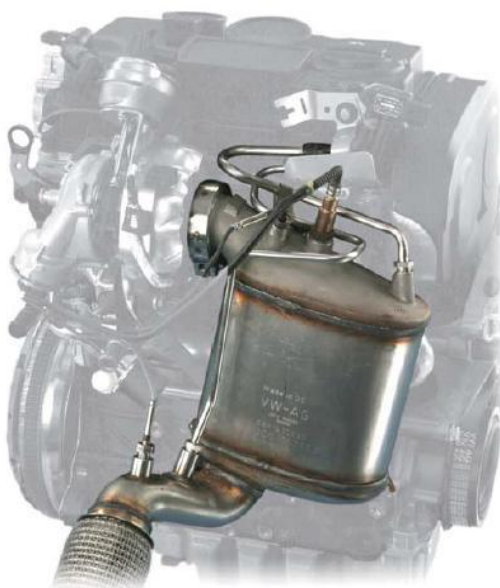
Obr. 4-8 Umístění filtru pevných částic (systém bez aditiv) na vozidle - 2.0 TDI PD 125kW [45]
