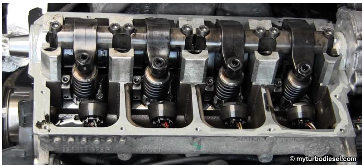
Obr. 1-7 Jednotlivé vstřikovací jednotky a ovládací vahadlo [74]
