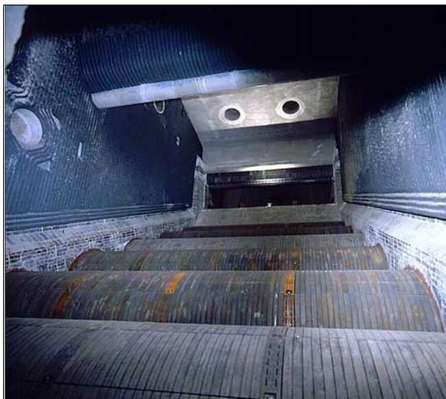
Obr. č. 3 Válcový rošt firmy FISIA-BABCOCK ENVIRONMENT GmbH [16]
