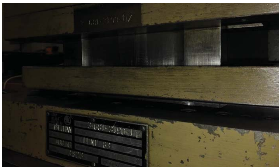
Obr. 3.2 Střížný nástroj pro normalizovaný vzorek (pro statickou zkoušku tahem)
