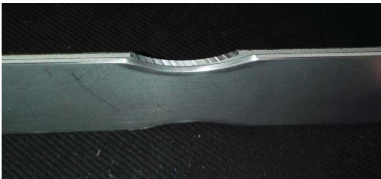
Obr. 3.9 Porovnání povrchů před a po broušení.
