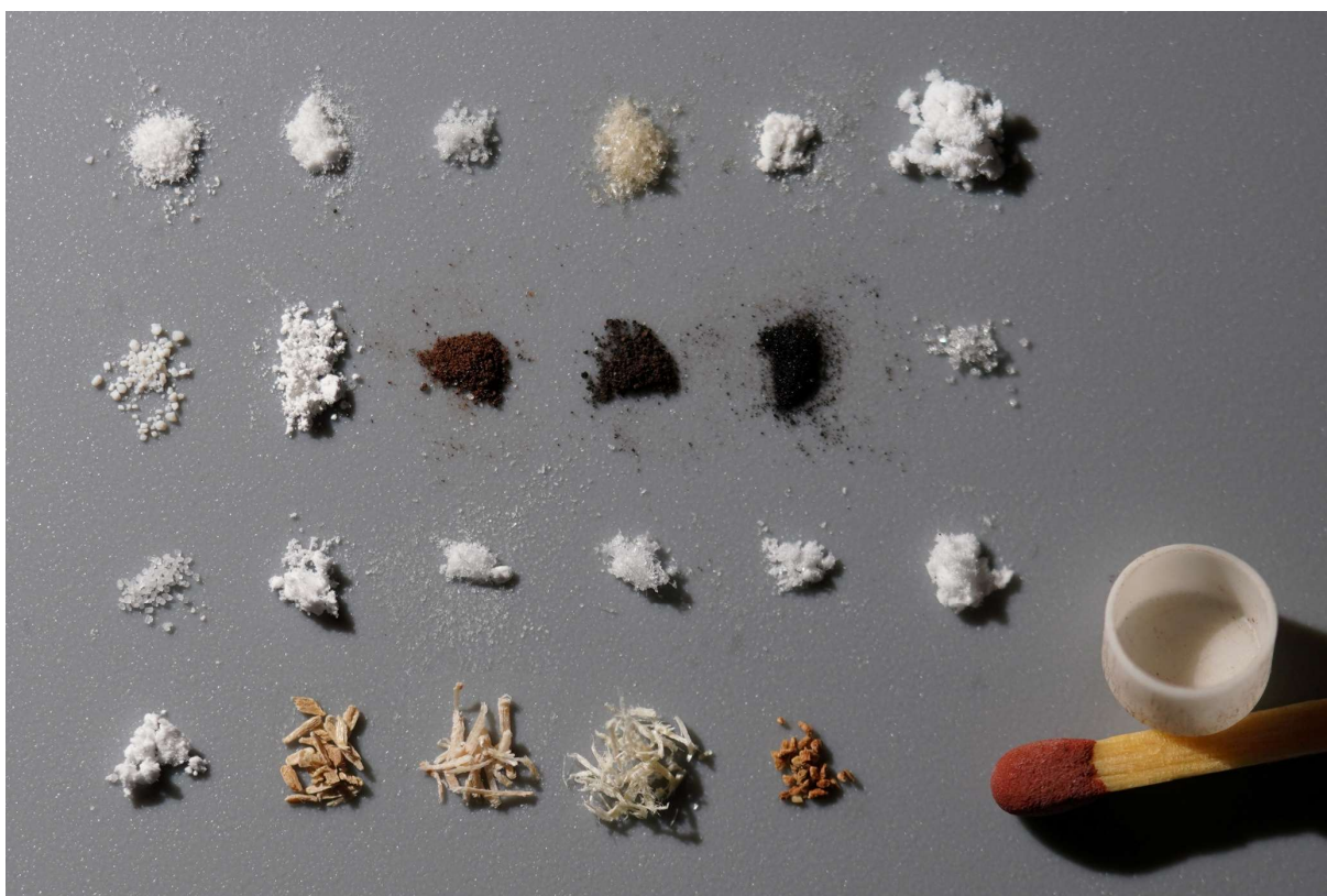
Obrázek 20.2. Zkoumané vzorky Icel-23bku (každý o hmotnosti 1 mg) a spalovací kelímek.
