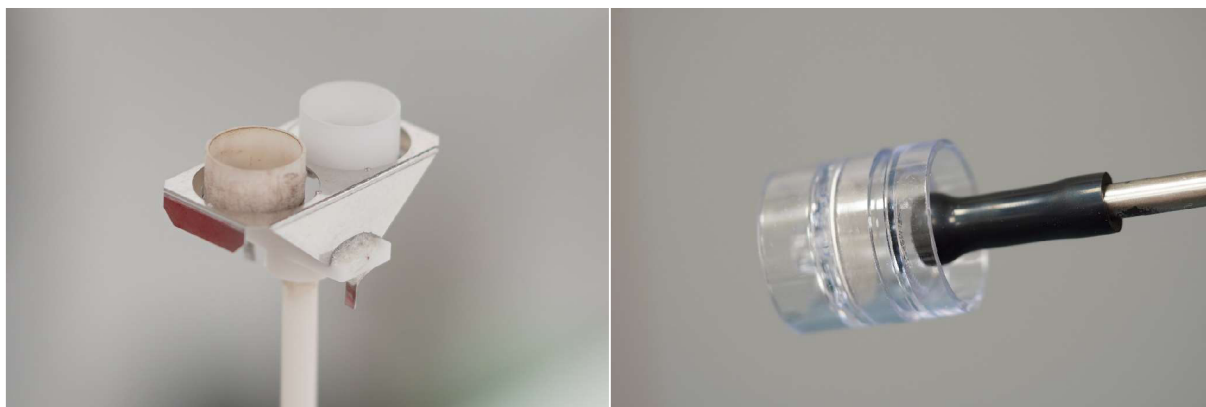
Obrázek 20.3. Dvojice spalovacích kelímků v TGA (vlevo) a kazeta pro záchyt částic na filtr (vpravo).
