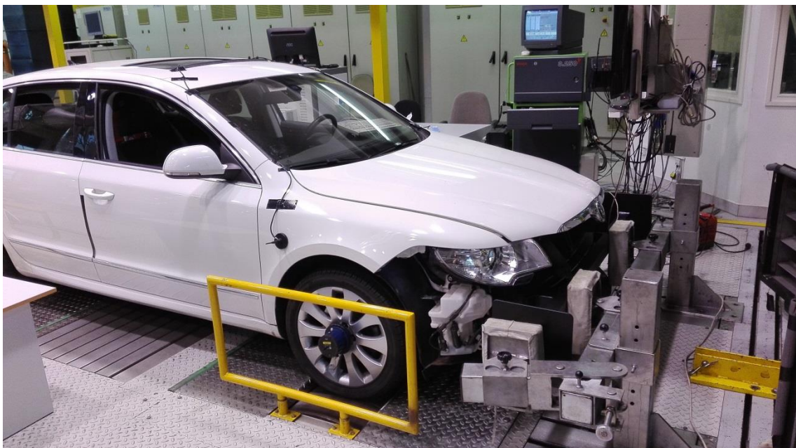
Obr. 13 Škoda Superb na válcovém dynamometru
