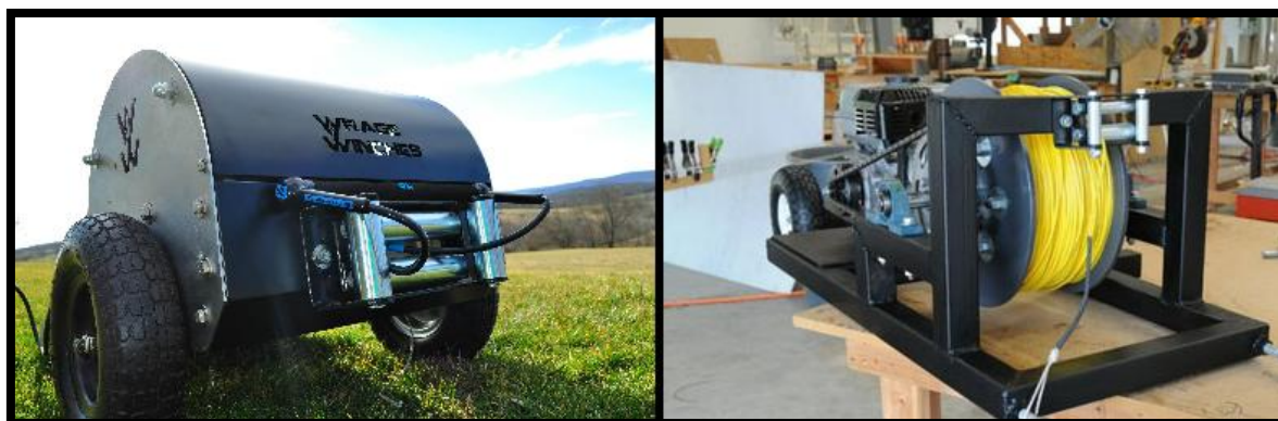
obr. 14 válečkové vedení lana [9], [10]
