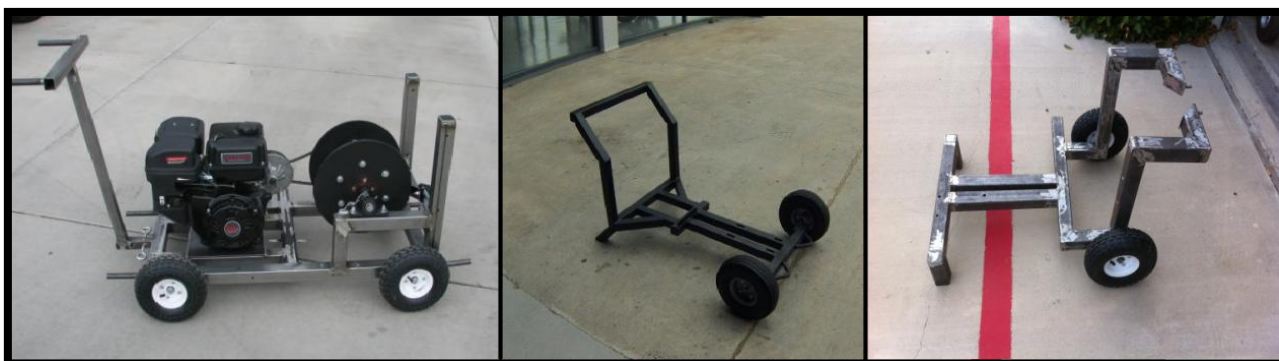
obr.6 typy možných konstrukcí rámu navijáku[10], [11]
