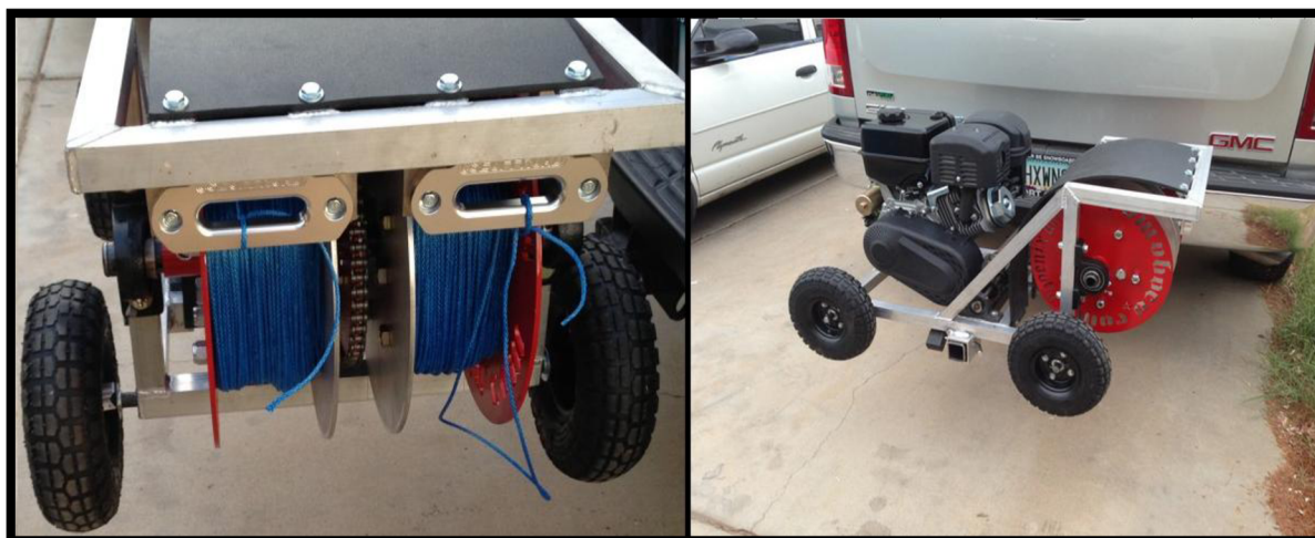
Obr. 18 naviják phoenixwinches 13HP se dvěma navýjecími bubny [7]
