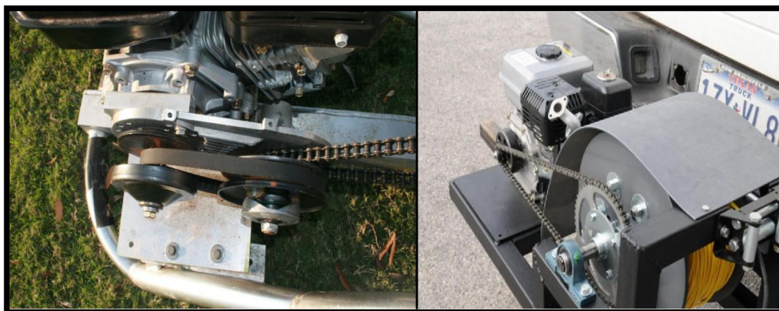
obr. 10 variátor a odstředivá spojka na navijáku [10], [11]
