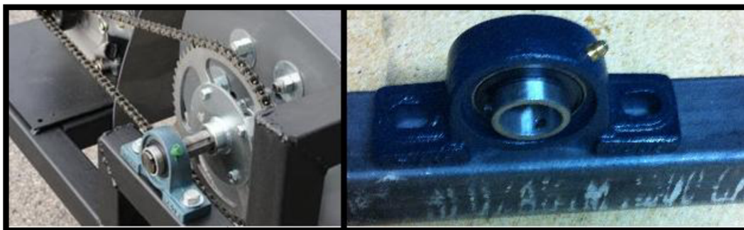
obr. 13 ložiskové jednotky s litinovým tělesem [10], [11]
