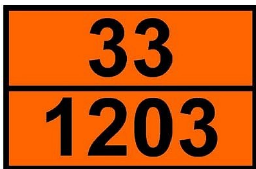
Obr. 2.3 Příklad oranžové tabulky s Kemlerovým kódem nebezpečnosti a UN kódem
