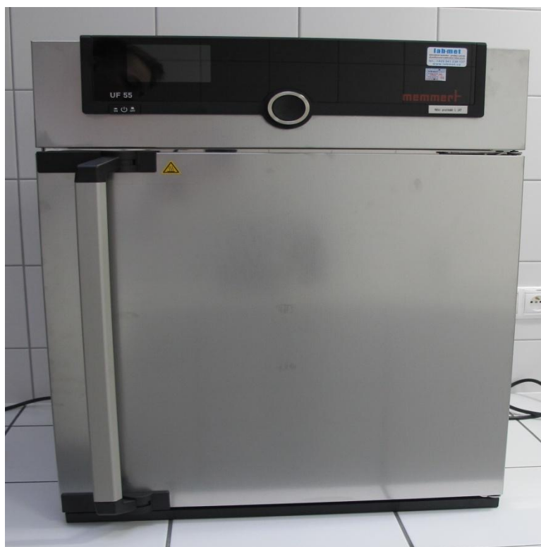
Obrázek 32: Sušička Mommert UF25 pro vysušení zeminy do konstantní hmotnosti.
