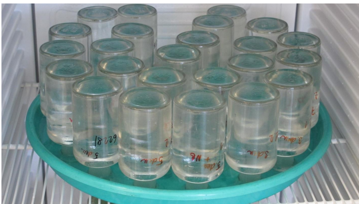
Obrázek 31: Vzorky připravené pro biochemickou spotřebu kyslíku uložené v boxu LOVI BOND TC 255 S.
