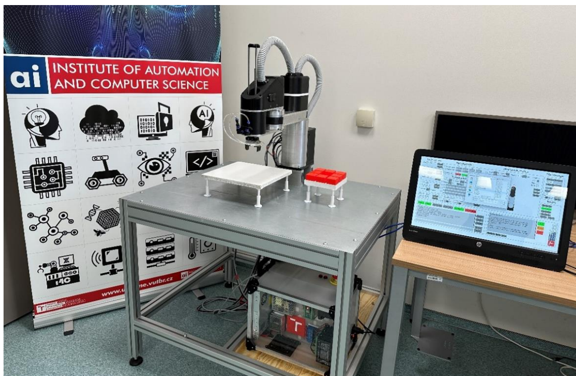
Obr. 91: Testovací pracoviště AI.SCARA robotu v laboratoři ÚAI I4C.
