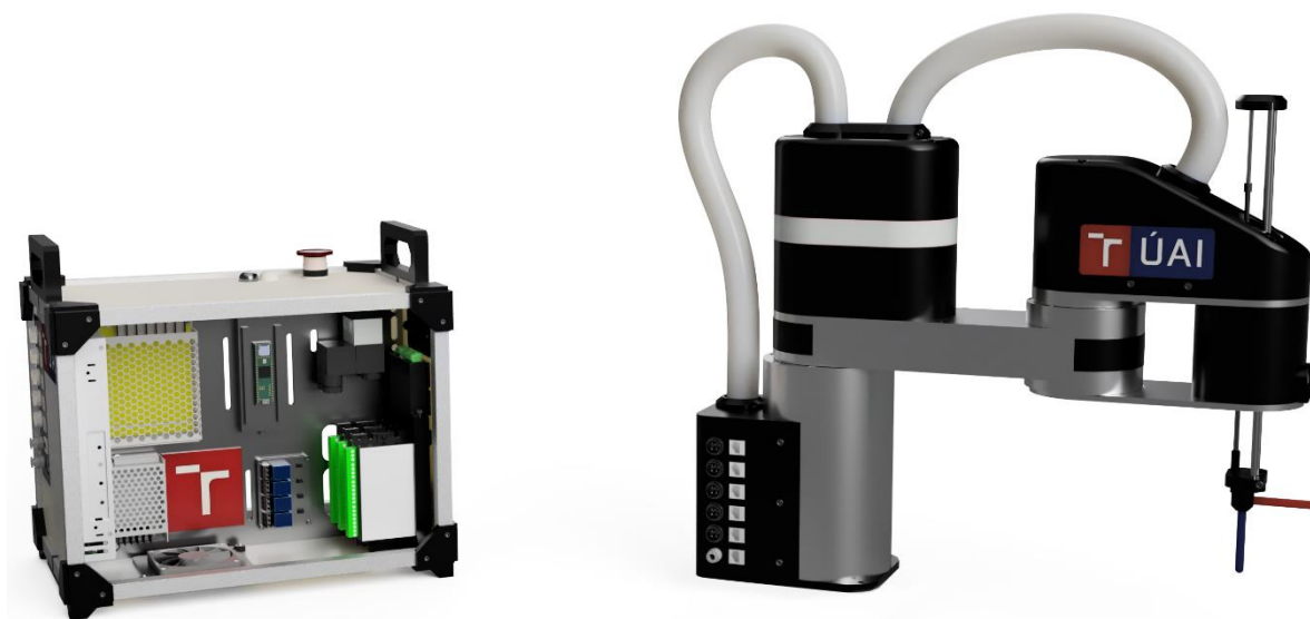
Obr. 30: Konečný návrh SCARA robotu a řídicího kontroléru.
