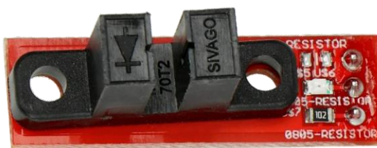
Obr. 48: Optický koncový spínač TCST2103 [68].
