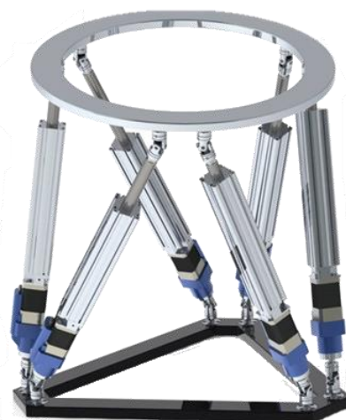
Obr. 3: Jedna z možných konstrukcí Stewartovy platformy [6].
