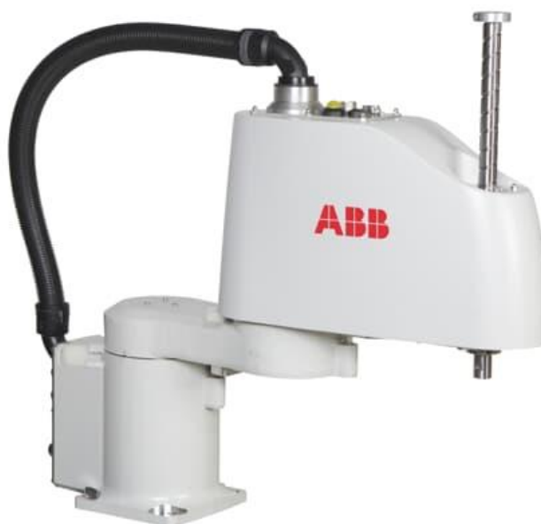
Obr. 15: ABB IRB 910SC (provedení s dosahem 450 mm) [27].
