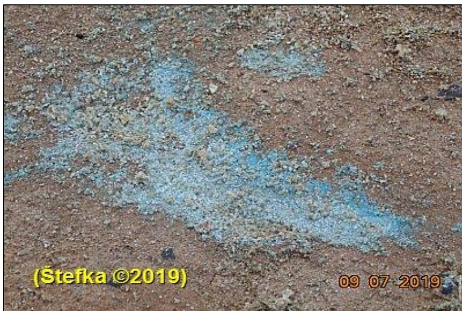
Obr. 3: Spodní odkaliště - pláž vodní plochy - loužení sulfidických minerálů
