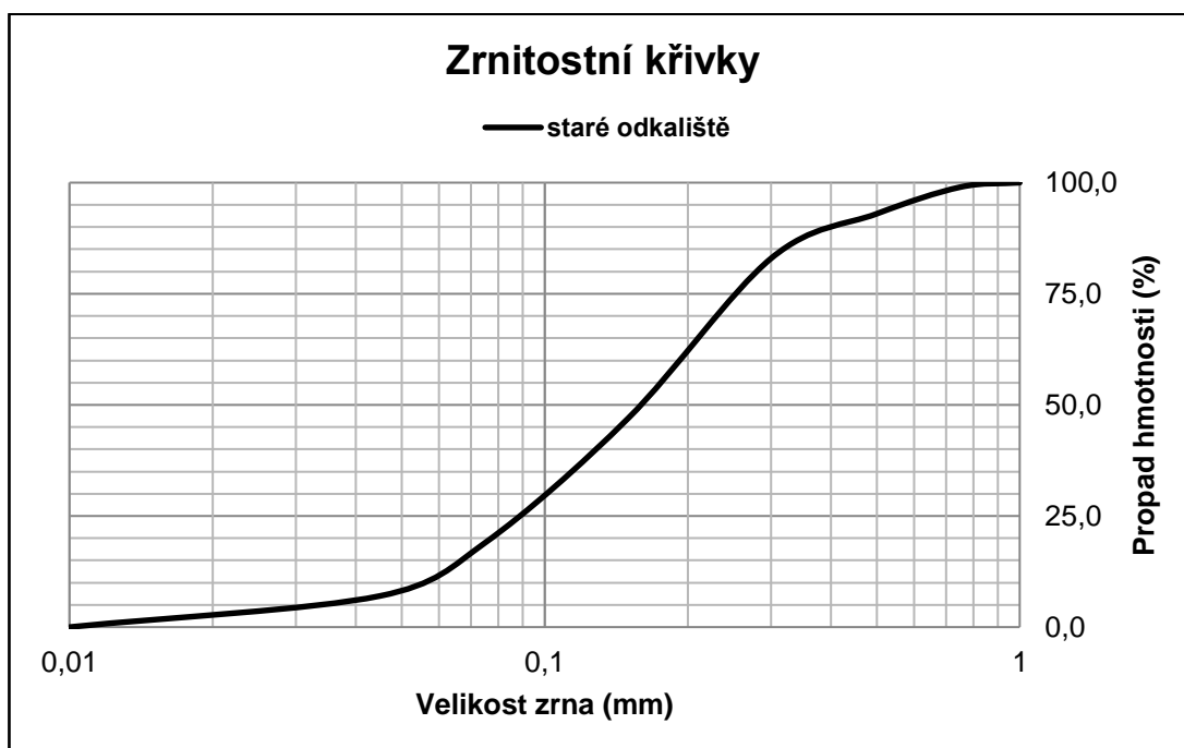
Obr. 13: Zrnitostní křivka - odpad staré odkaliště (1964)
