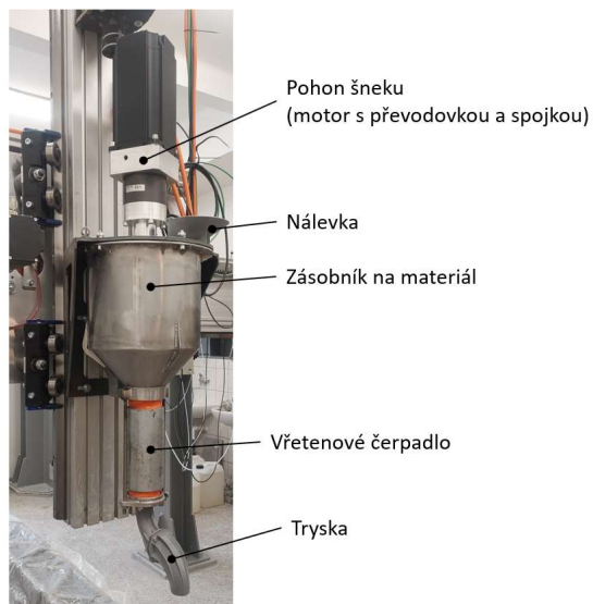
Obr. 3.17 Nanášecí hlava použitá na zařízení TestBed s vřetenovým čerpadlem
