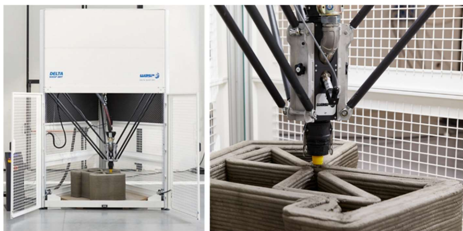
Obr. 3.8 Ukázka 3D tiskárny Delta WASP 3MT CONCRETE od firmy WASP [19]
