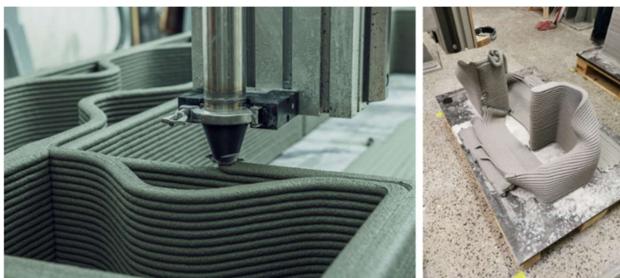
Obr. 3.2 Ukázka tisku metodou CC (vlevo), ukázka ztráty stability tisknutého objektu (vpravo) [2]
