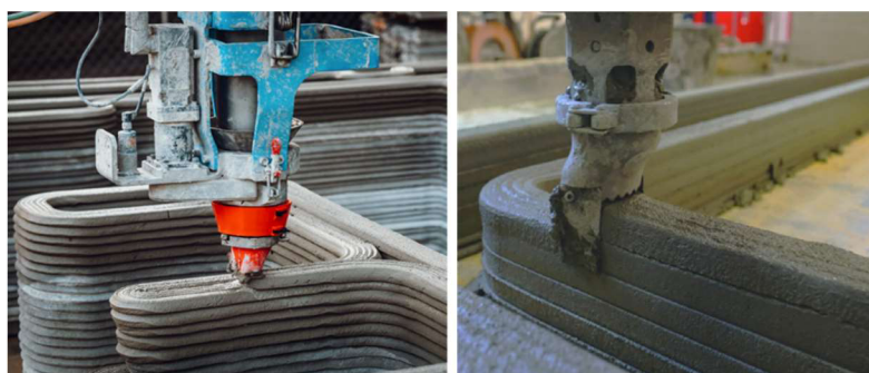
Obr. 3.20 Nanášecí hlava s otočnou tryskou (vlevo)[31], nanášecí hlava s bočními hladítky (vpravo)[15]
