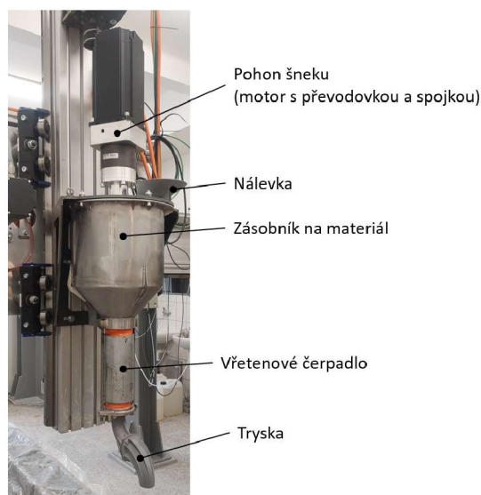
Obr. 3.17 Nanášecí hlava použitá na zařízení TestBed s vřetenovým čerpadlem
