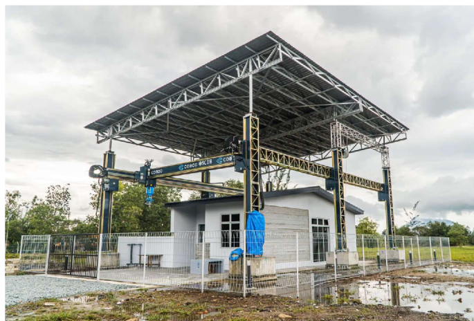
Obr. 3.6 Tiskové zařízení dánské firmy COBOD (vlevo)[16]
