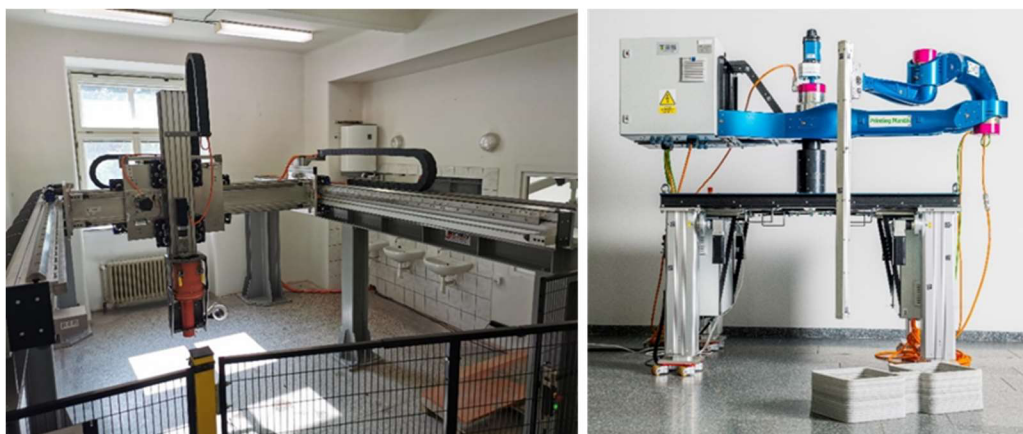
Obr. 3.1 Testovací zařízení: TestBed (vlevo), Printing Mantis (vpravo) [2]
