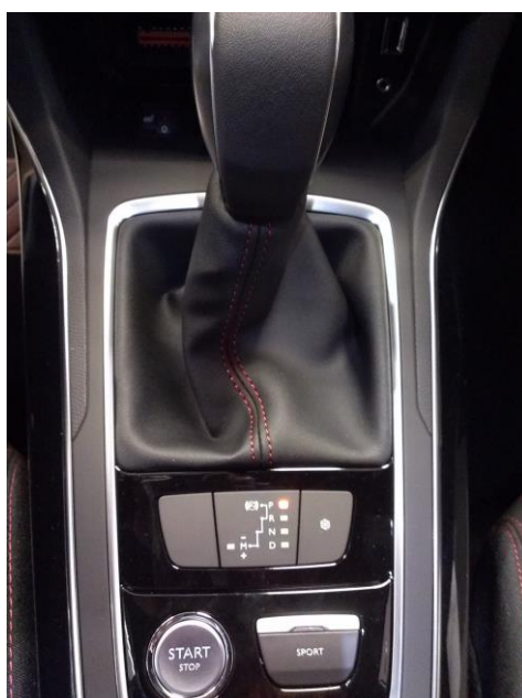
Obrázek 11: Nový typ kulisy řazení
