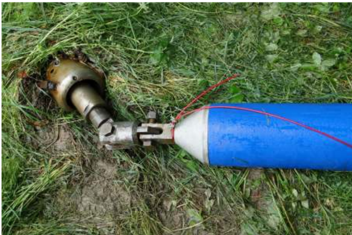
Obr. 2.4 Vrtná hlava se zaháknutým vtahovaným potrubím [17]
