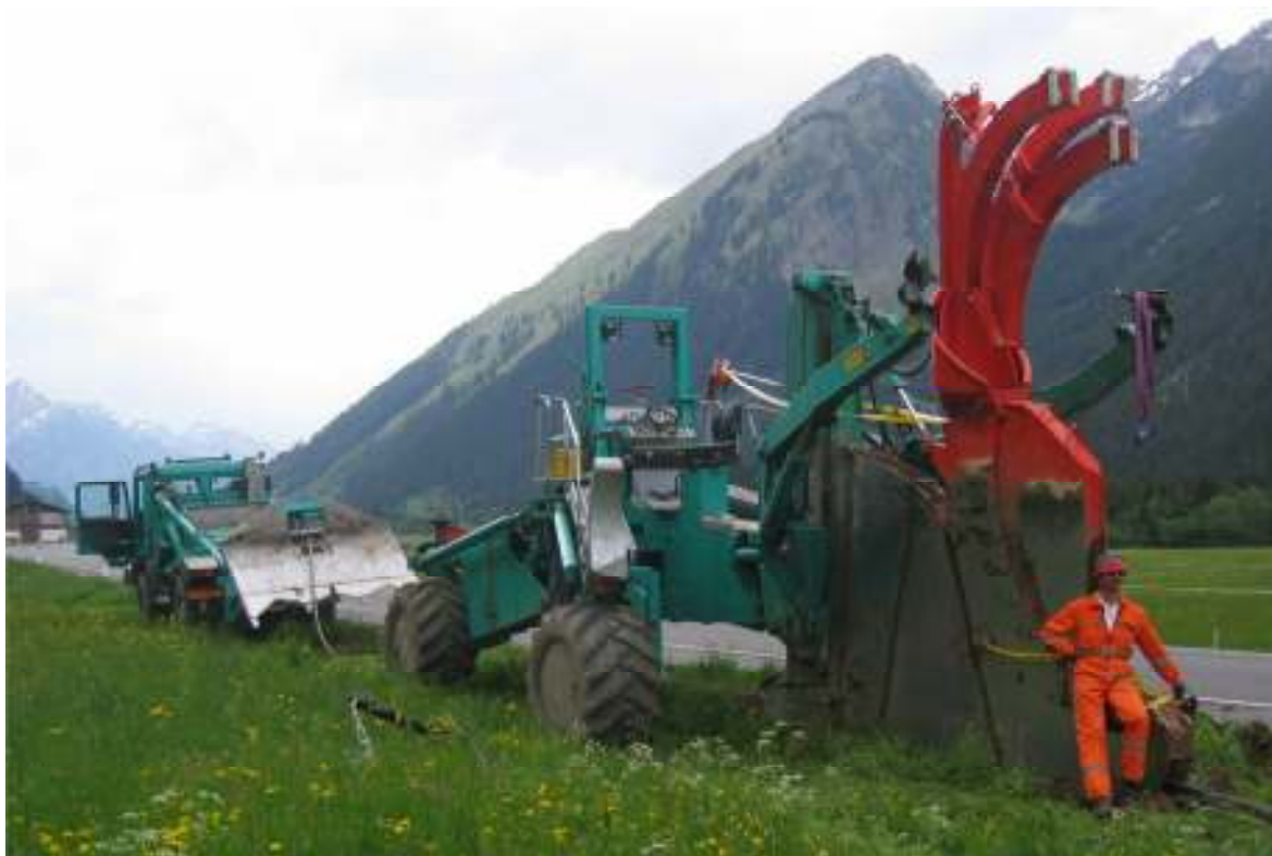
Obr. 2.1 Základní strojní sestava pro pluhování [15]
