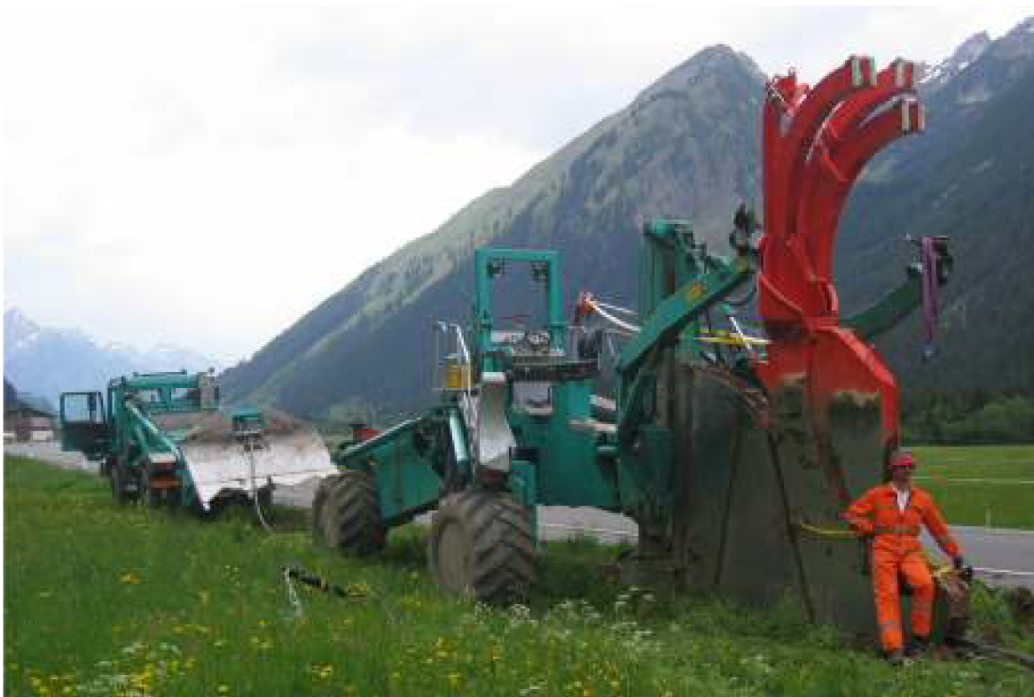
Obr. 2.1 Základní strojní sestava pro pluhování [15]
