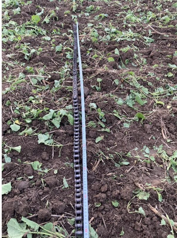
Obrázek 6 Válečkový řetěz pro měření drsnosti povrchu pozemku
