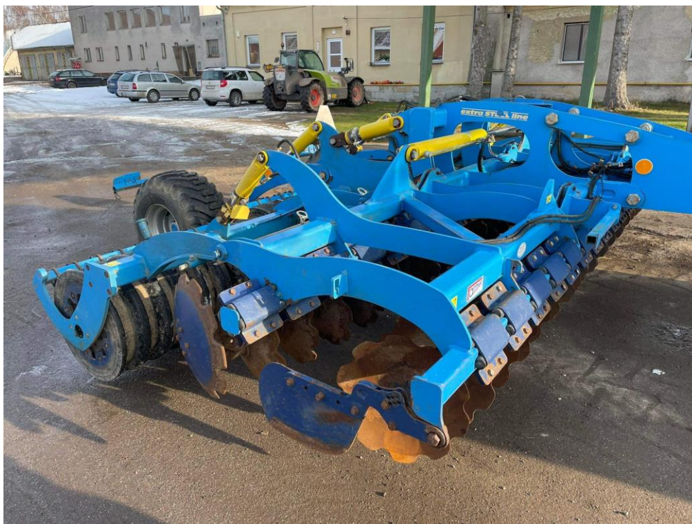
Obrázek 2 Taliřový podmítací stroj Farnet Softer
