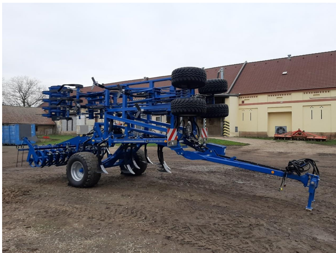
Obrázek 3 Radličkový podmítač Köckerling Vector
