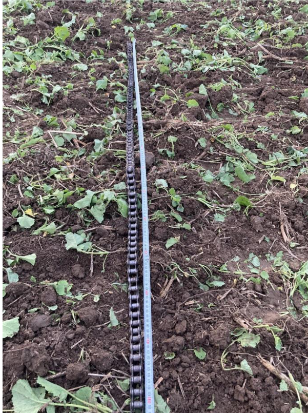
Obrázek 6 Válečkový řetěz pro měření drsnosti povrchu pozemku
