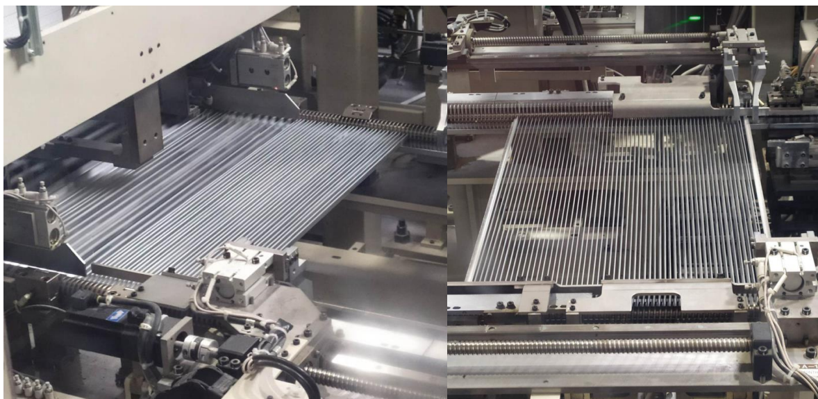
Obr. 23: Sestavování tepelného výměníku
