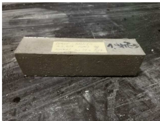
Obrázek 13 – BL110F, ve stáří uložení ve fólii v laboratoři 28 dní
