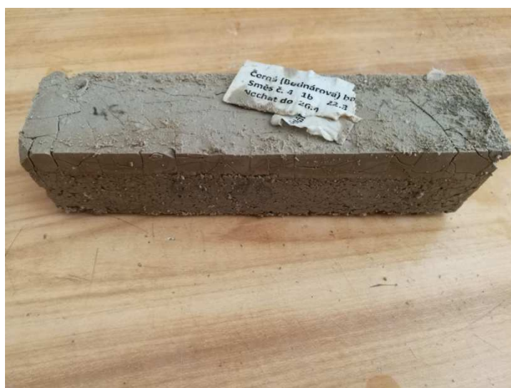
Obrázek 23 – Směs BL85FS, po 100 cyklech mrazuvzdornosti
