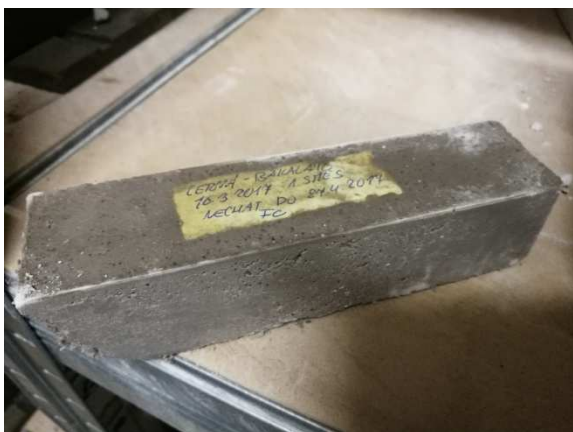
Obrázek 12 – BL110F, ve stáří 1 den , uložení v laboratoři
