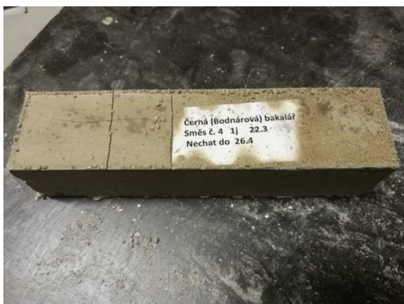
Obrázek 21 – BL85FS, ve stáří 1 den, uložení v laboratoři
