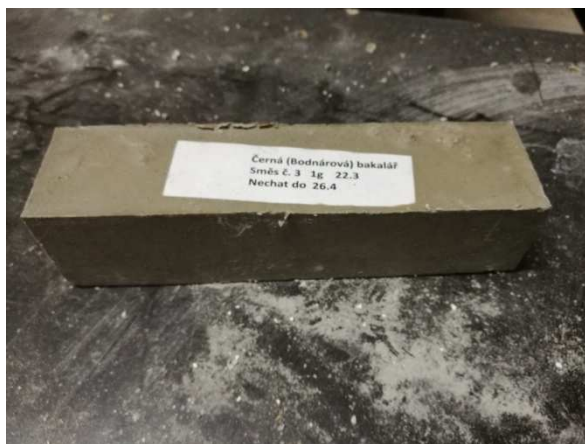
Obrázek 18 – BL110FS, ve stáří 1 den, uložení v laboratoři
