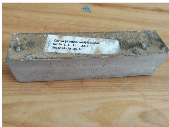
Obrázek 22 – BL85FS, ve stáří 28 dní uložení ve fólii v laboratoři
