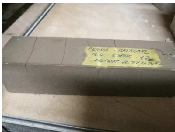
Obrázek 15 – BL85F, ve stáří 1 den, uložení v laboratoři
