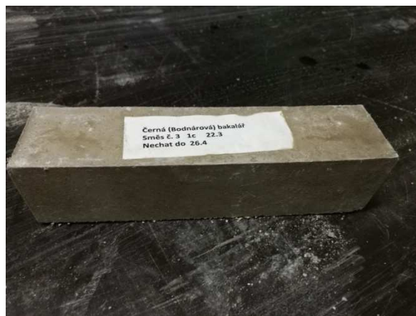
Obrázek 19 – BL110FS, ve stáří 28 uložení ve fólii v laboratoři dní
