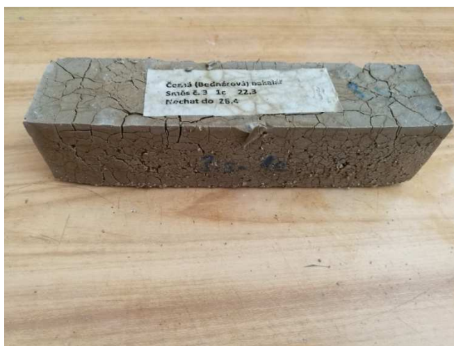
Obrázek 20 – Směs BL110FS, po 100 cyklech mrazuvzdornosti
