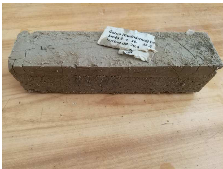
Obrázek 23 – Směs BL85FS, po 100 cyklech mrazuvzdornosti
