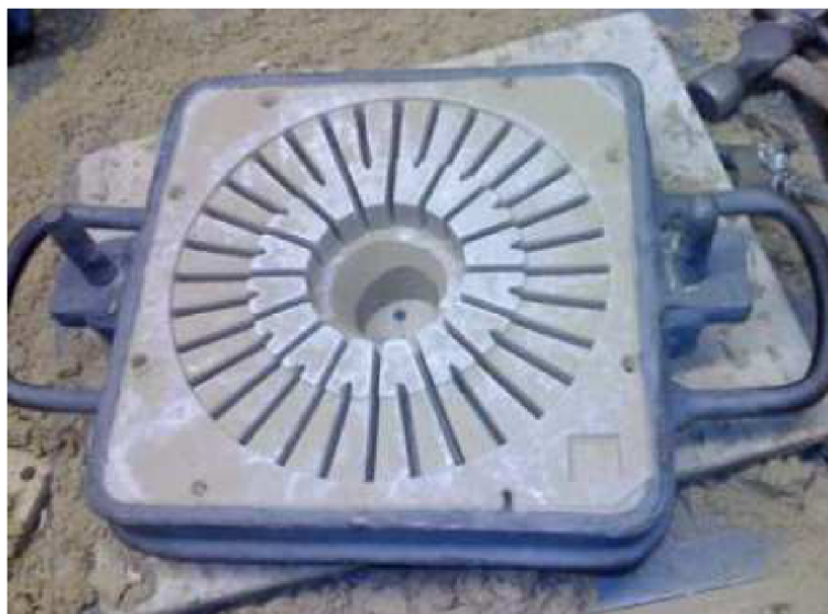
Obrázek 7 - Forma pro výrobu bronzových odlitků [2]
