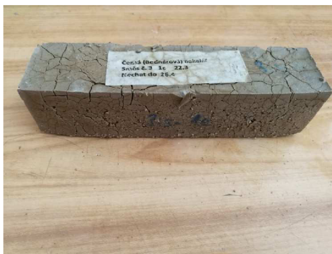
Obrázek 20 – Směs BL110FS, po 100 cyklech mrazuvzdornosti
