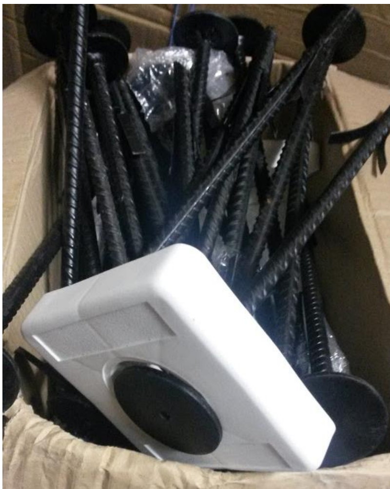
Obr. č. 12: Použité geodetické označovníky z roxoru s přivařenými protipohybovými listy. Foto autor.
