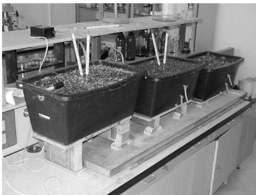
Obr. 8: Model kořenové čistírny (Prokešová, 2006)
