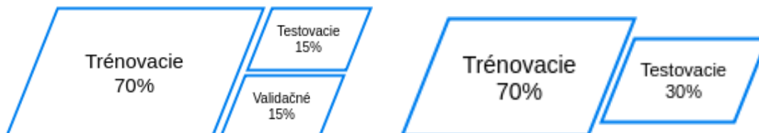
Obr. 4.5: Rozdelenie dát do skupín, na 3 skupiny pre CNN a na 2 skupiny pre K-means a SVM klasifikátor.
