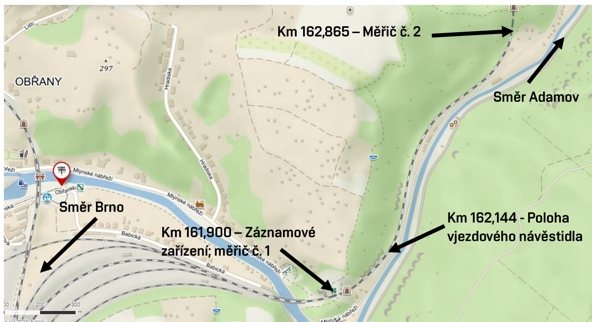
Obrázek 8: Lokalita „Hády“, situace a osazení měřicí aparatury
