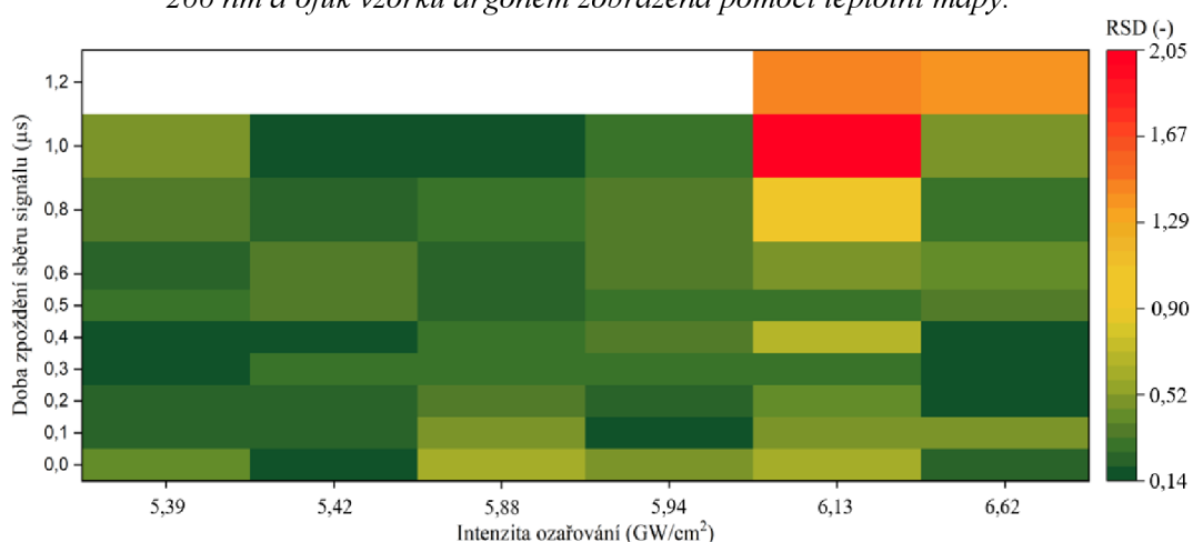
Obrázek 12: Závislost relativní směrodatné odchylky (RSD) SNR na intenzitě ozařování a době zpoždění sběru signálu pro vlnovou délku 266 nm a ofuk vzorku argonem zobrazena pomocí teplotní mapy.
