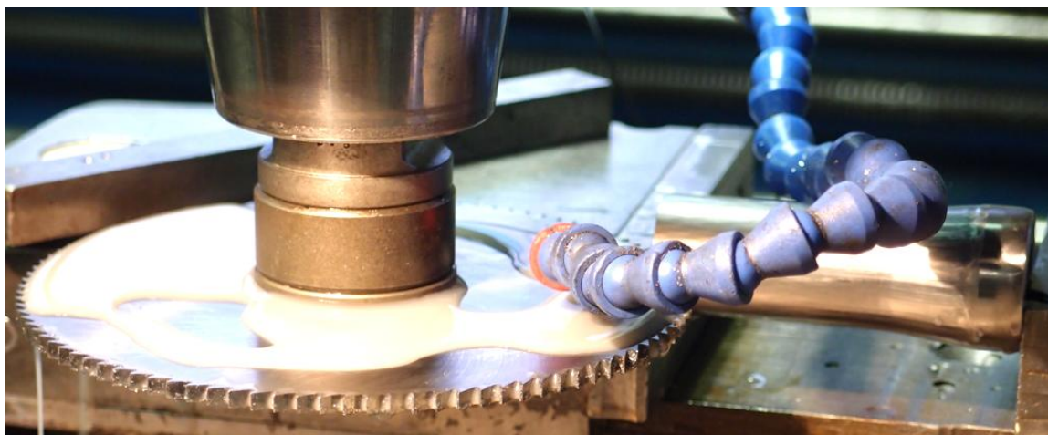
Obr. 3.1.1 Dělení vzorku na horizontální frézce
