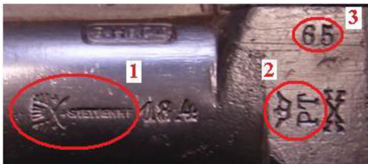
Obr. 2.3.12 Hodnota jmenovitého průměru průchozího kalibru 18,4 mm vyražena výrobcem; dále jsou na obrázku patrné vyražené zkušební značky Francouzské republiky viz. Legenda
