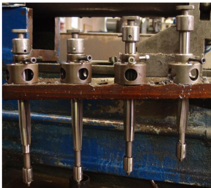
Obr. 2.3.12 Sada tvarových výhrubníků a výstružníků pro výrobu nábojové komory
