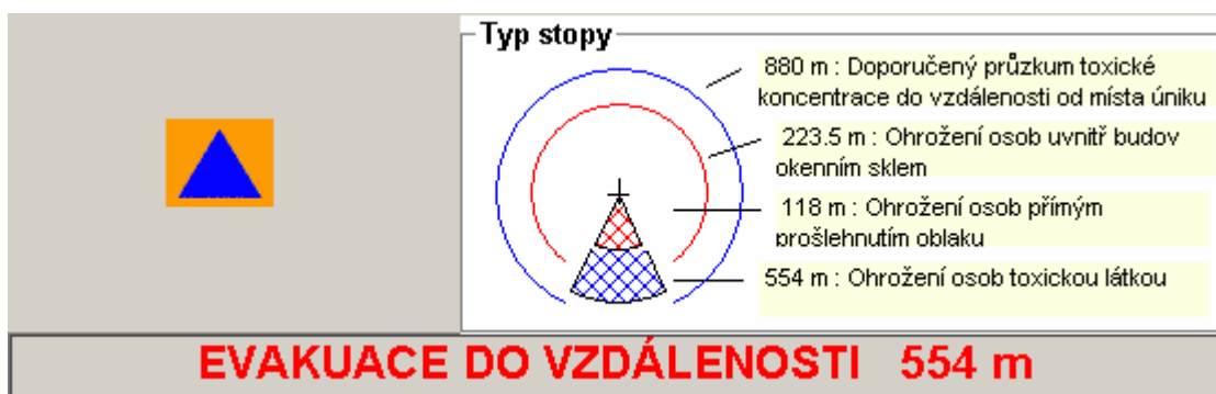
Obrázek č.5 – Znárodnění šíření a dosahu amoniaku při náhlém výronu chladiva
