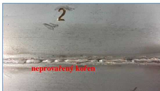
b) kořenová část svaru
