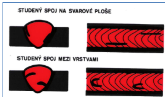
obr. 20 Vnitřní vady svarů - studený spoj a neprůvar [7]
