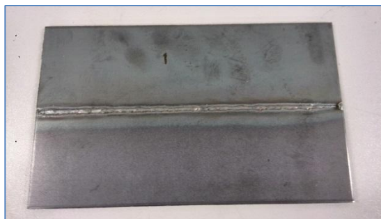
b) kořenová část svaru
