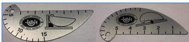
obr. 30 Jednoduchá měrka svaru
