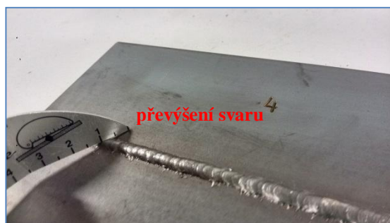
obr. 36 a) mírně převýšený svar
