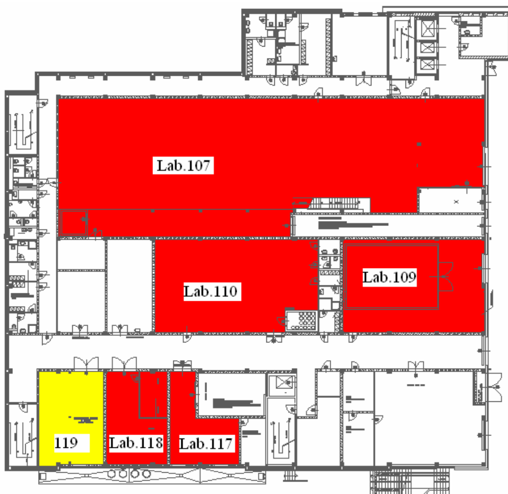
Obr.2.2-1 Místa vzniku odpadního tepla
