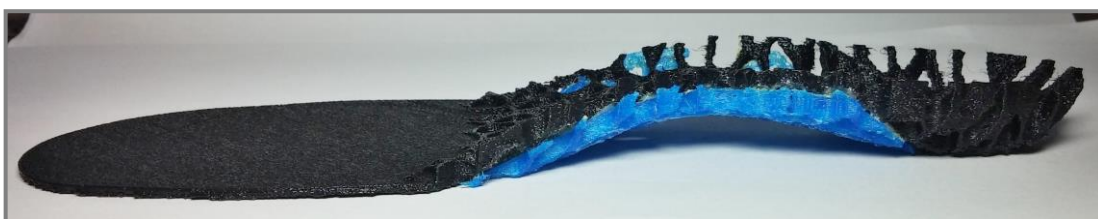
Obr. 4.11 Konečný výtisk ortopedické vložky z boku
