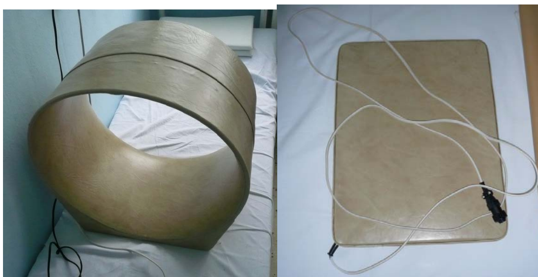
Obr. 5.3 Aplikátory magnetoterapeutického přístroje MTU 500H vlevo válcový (B01) a vpravo deskový (B03).
