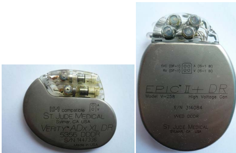
Obr. 5.7 Implantabilní kardiostimulátor (vlevo) a defibrilátor (vpravo) firmy ST JUDE MEDICAL
