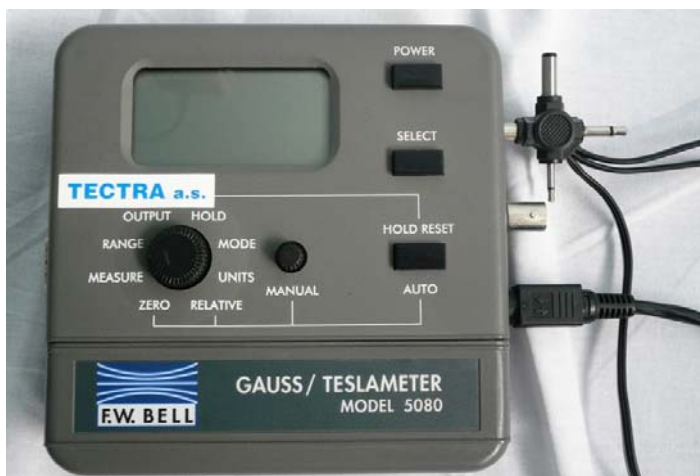
Obr. 5.6 Měřič magnetické indukce F.W.BELL Model 5080
