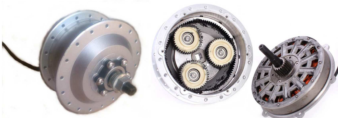
Obr. 12 - Elektromotor s planetovou převodovkou [21]
