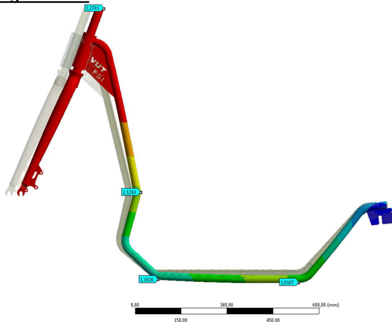
Obr. 54 - Deformace rámu, profil \text{Ø}25 \times 3,0 , situace 1
