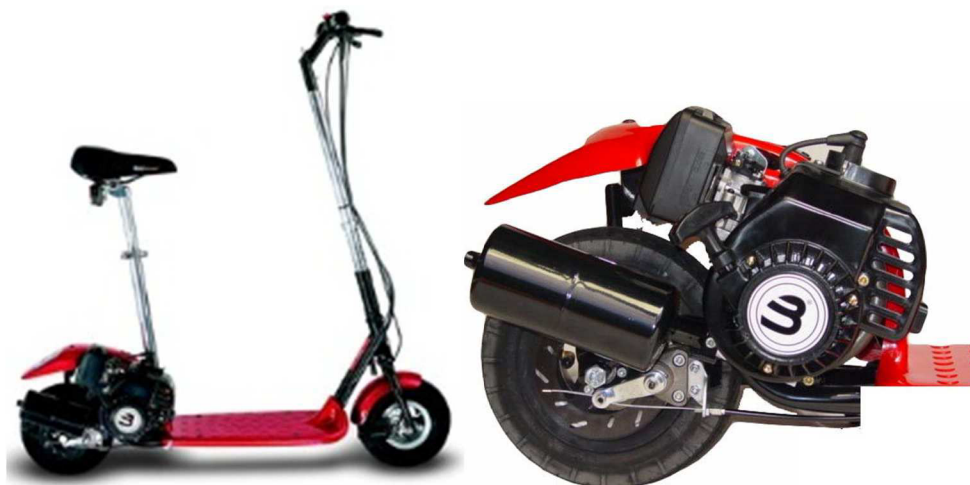
Obr. 10 – Koloběžka Blatino poháněná spalovacím motorem
