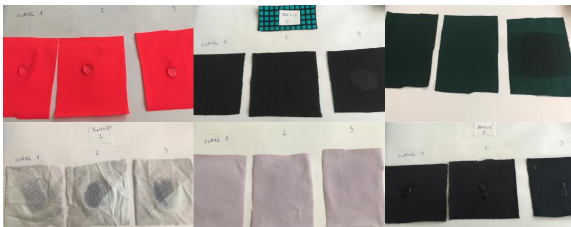
Obrázek 25 - ukázka chování vybraných druhů materiálu v rámci měření vlhkosti
