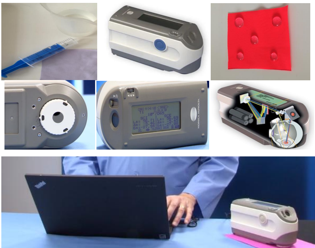
Obrázek 27 - Spectrofotometr 2500d Minolta, připravený mokrý vzorek
