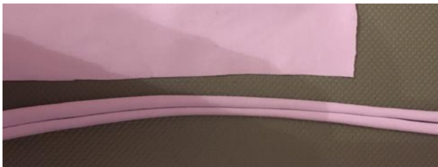
Plastická deformace materiálu bez vrácení do původního stavu pouhým ručním natežením
