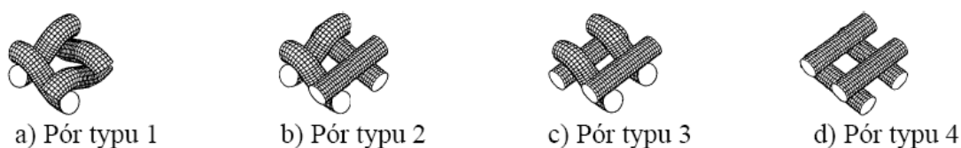
Obrázek 7 Typy pórů dle Backera[12]
