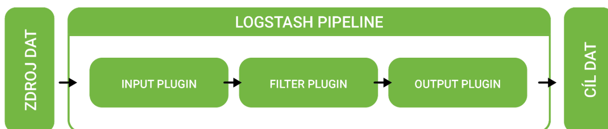
Obrázek 7 Vnitřní architektura nástroje Logstash (vlastní)
