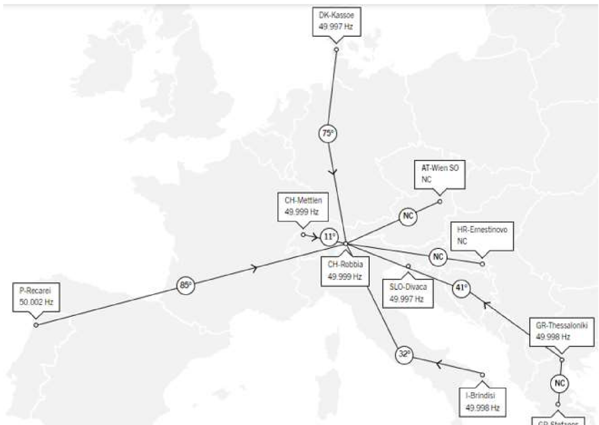
Obrázek 2: Okamžitá frekvence a úhly fázorů sítě - zdroj www.swissgrid.ch
