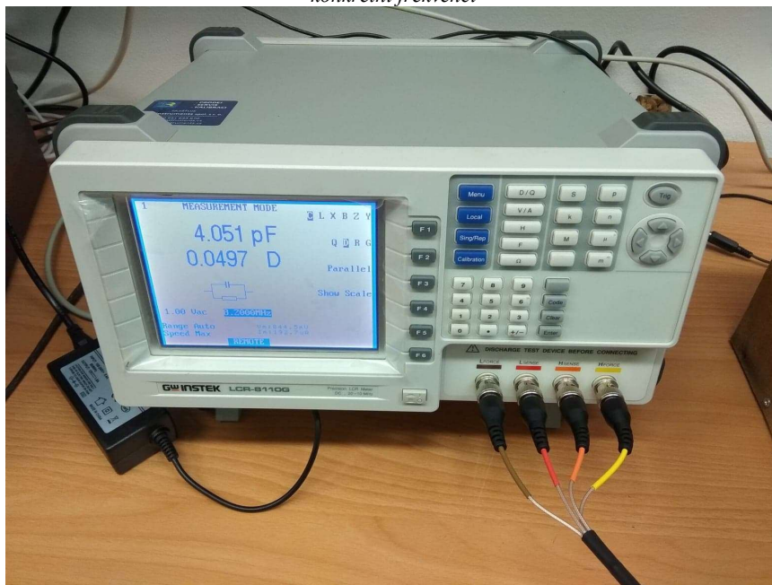
Obrázek 10 - LCR můstek s detailnějším záběrem měření a vyobrazením hodnot elektrické kapacity a ztrátového faktoru při konkrétní frekvenci
