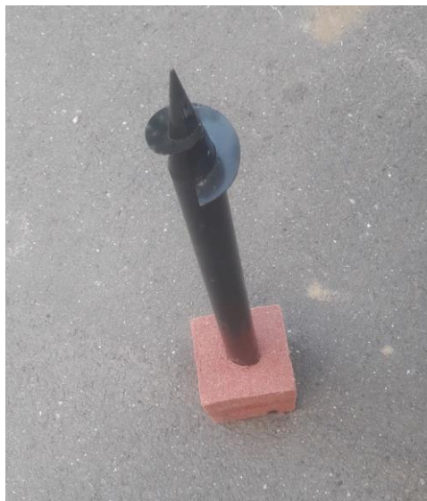
Obr. 5.1-3 Železná trubka s plastovou hlavou
