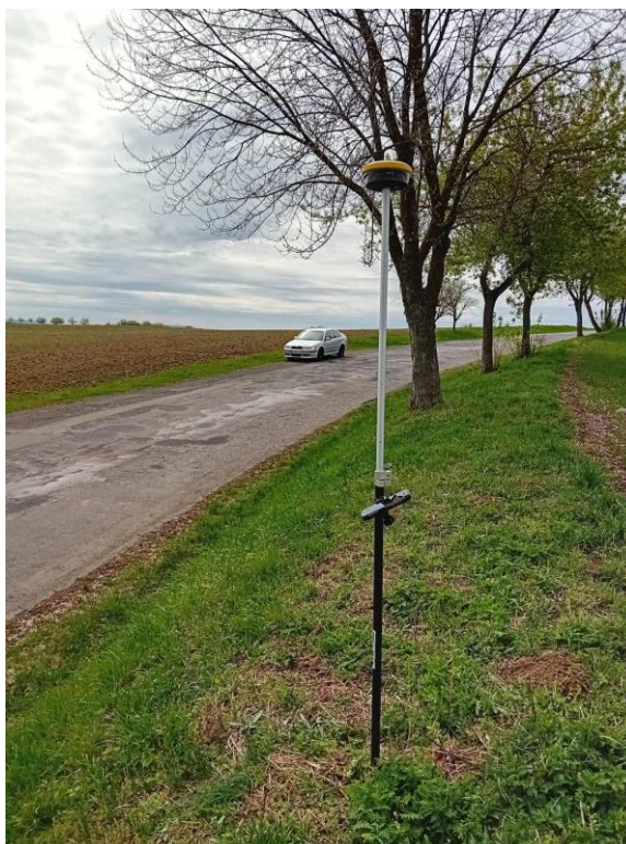
Obr. 6-2 Ukázka terénních prací v rámci výškového připojení
