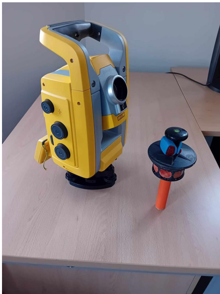
Obr. 5.2-3 Totální stanice Trimble S3 a hranol
