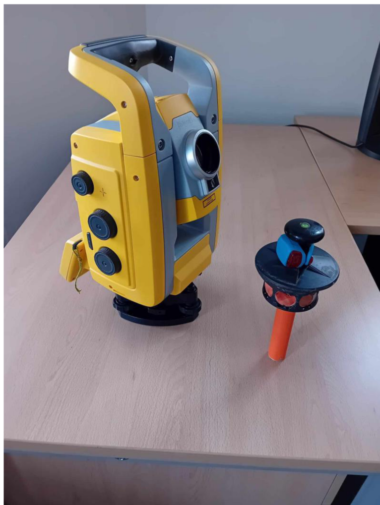
Obr. 5.2-3 Totální stanice Trimble S3 a hranol
