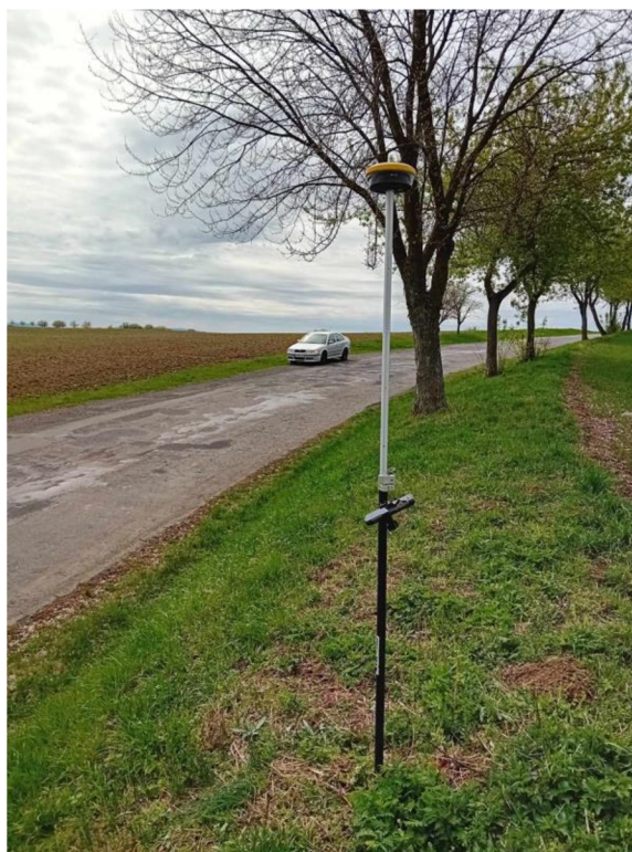
Obr. 6-2 Ukázka terénních prací v rámci výškového připojení
