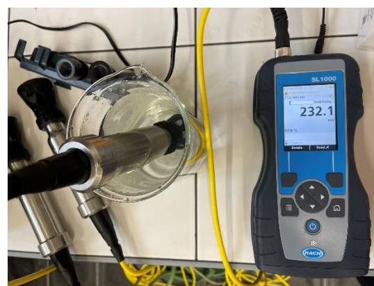
Obr. 7.12 Měření ORP, pH a vodivosti odebraného vzorku [autor]
