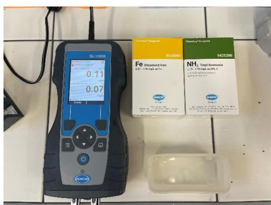
Obr. 7.13 Měření železa a amoniaku odebraného vzorku [autor]
