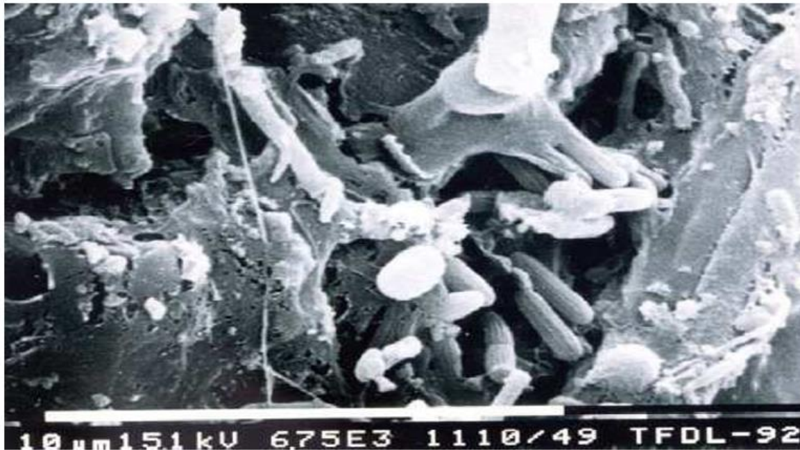
Obr. 5.3 Částice GAU po 6 měsících ve filtru v pitné vodě [36]
