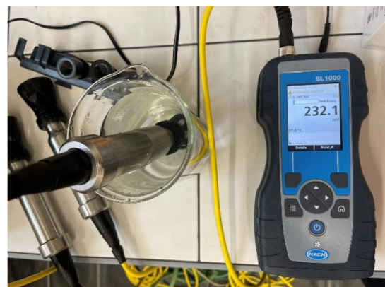
Obr. 7.12 Měření ORP, pH a vodivosti odebraného vzorku [autor]
