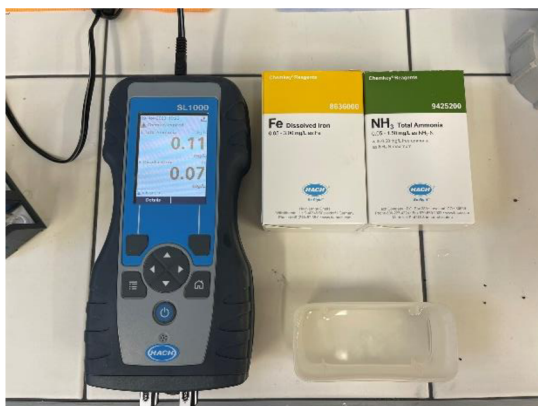
Obr. 7.13 Měření železa a amoniaku odebraného vzorku [autor]
