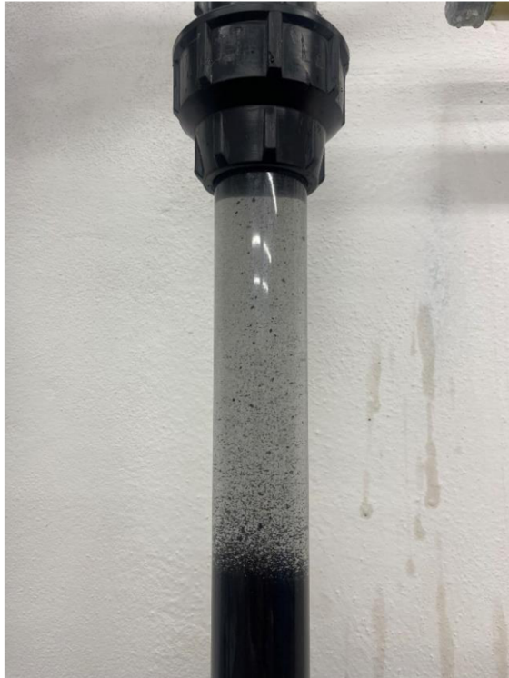
Obr. 7.5 Začátek a konec praní filtračního materiálu Filtrasorb F400 [autor]
