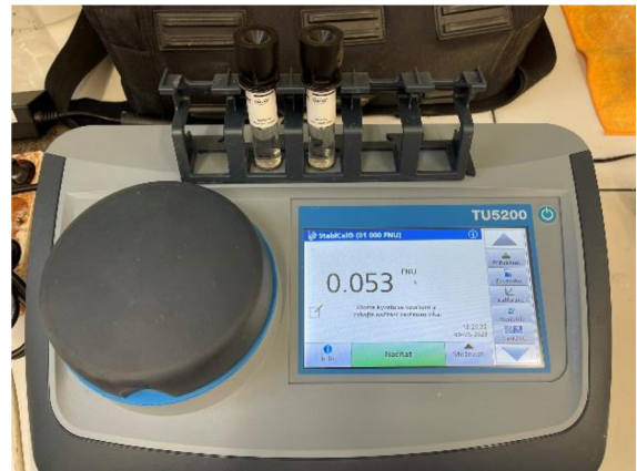
Obr. 7.10 Měření zákalu odebraného vzorku [autor]
