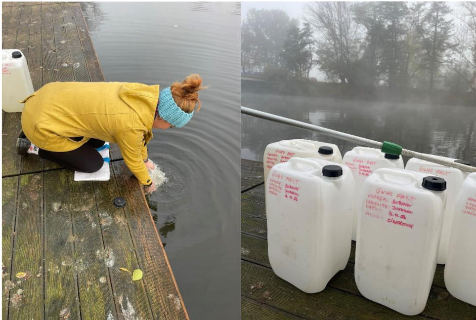
Obr. 7.4 Odběr surové vody [autor]
