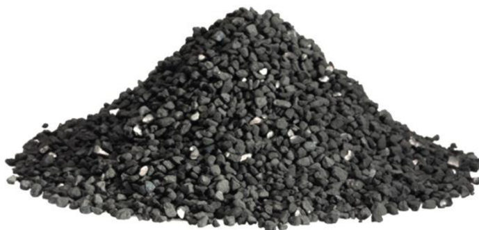
Obr. 7.1 Granulované aktivní uhlí Filtrasorb F400 [autor]
