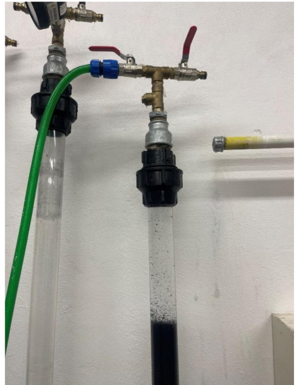
Obr. 7.5 Začátek a konec praní filtračního materiálu Filtrasorb F400 [autor]
