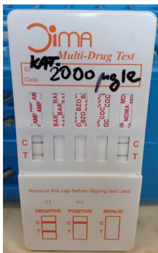
Obr. 8. Screening kathinonů v moči o koncentraci 2000 µg/l na destičce Multi-Drug Test.
