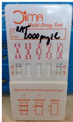
Obr. 8. Screening kathinonů v moči o koncentraci 2000 µg/l na destičce Multi-Drug Test.
