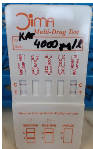
Obr. 9. Screening kathinonů v moči o koncentraci 4000 µg/l na destičce Multi-Drug Test.
