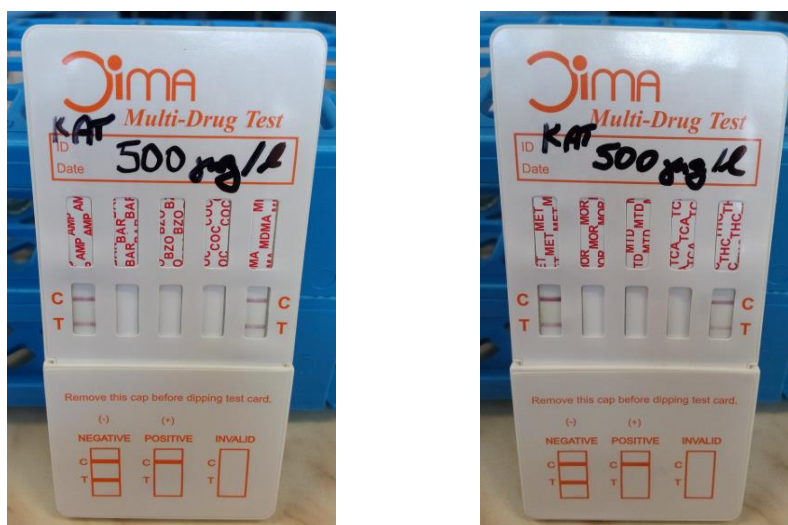
Obr. 7. Screening kationů v moči o koncentraci 500 \mu\text{g/l} na destičce Multi-Drug Test.
