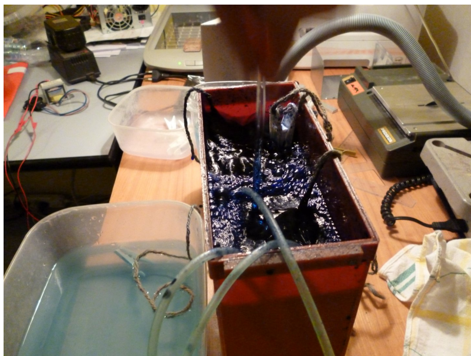
Obr. A.5: Leptanie v alkalickom prostredí
