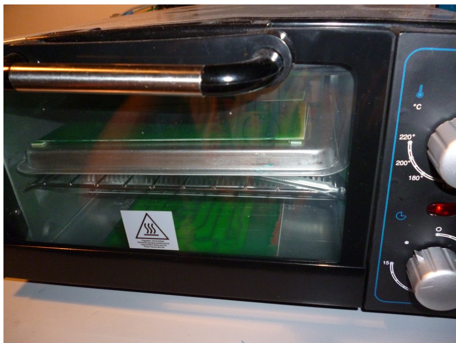
Obr. A.9: Vytvrdzovanie nepájivej masky
