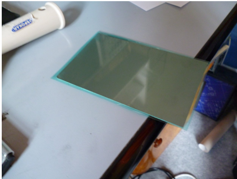
Obr. A.1: Nanesená fotorezistívna fólia
