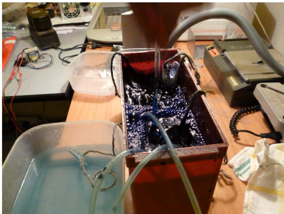
Obr. A.5: Leptanie v alkalickom prostredí
