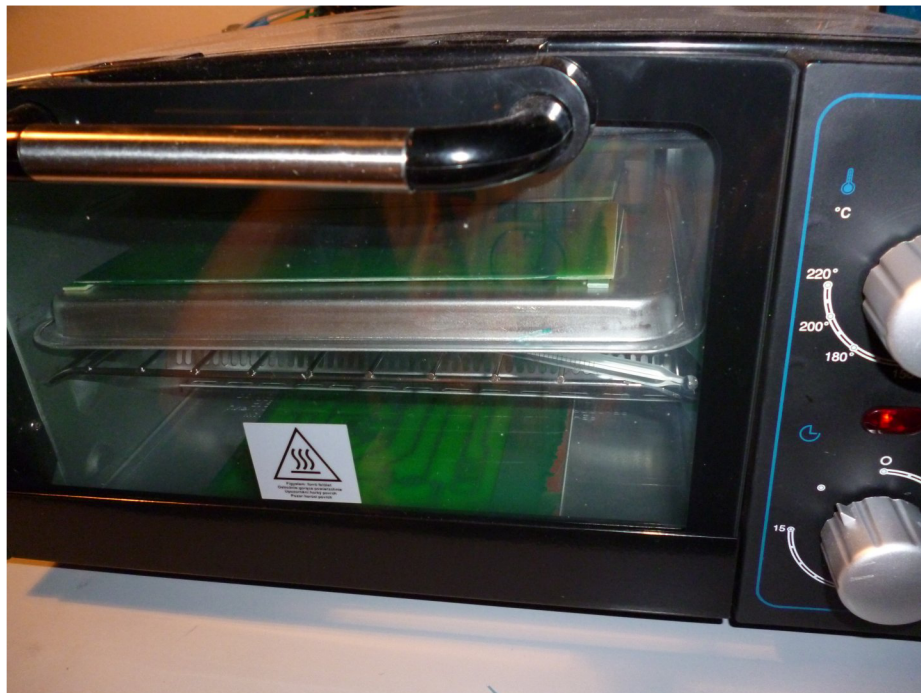
Obr. A.9: Vytvrdzovanie nepájivej masky
