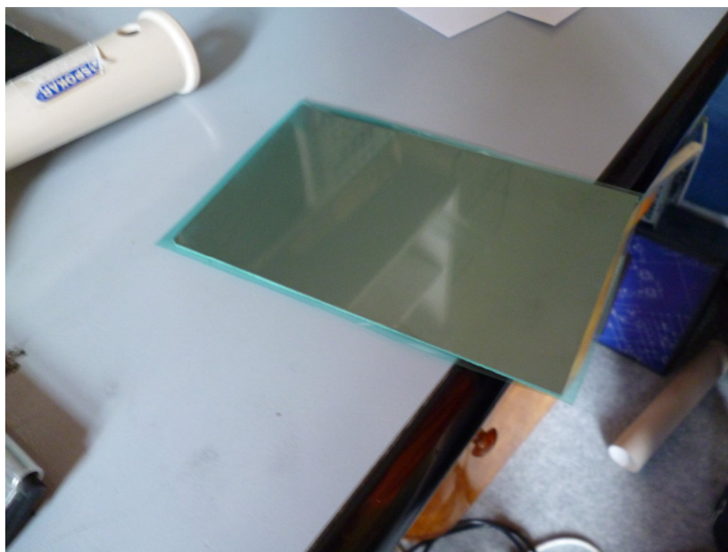
Obr. A.1: Nanesená fotorezistívna fólia
