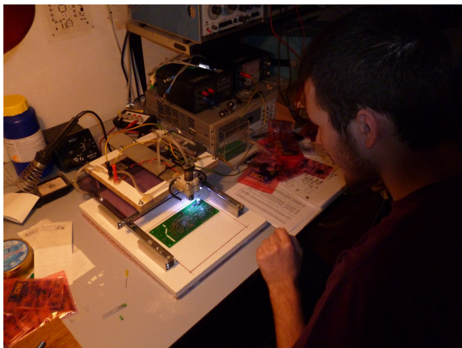
Obr. A.15: Osádzanie SMD súčiastok vákuovou pinzetou
